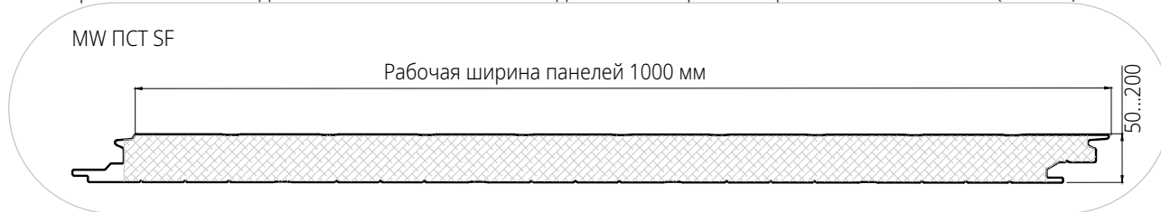
Рисунок 2. Геометрия стеновой сэндвич-панели с замковым соединением скрытого крепления SECRET FIX (ПСТ SF)
